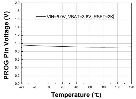
11. PROG 端上拉电流 VS 温度
