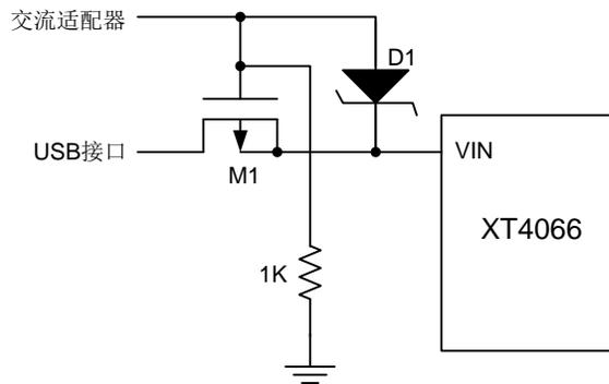
图 1. 同时使用交流电适配器和 USB 接口
