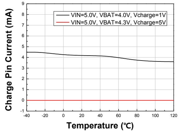
15. 涓流充电电流 VS 温度
