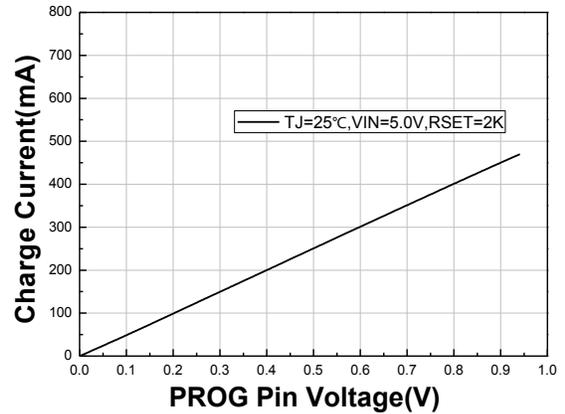
3. 充电电流 VS 输入电压
