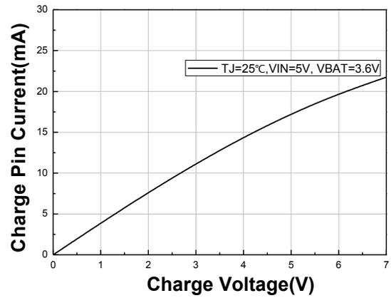
5. CHARGE 端电流 VS CHARGE 端电压 (充满电)
