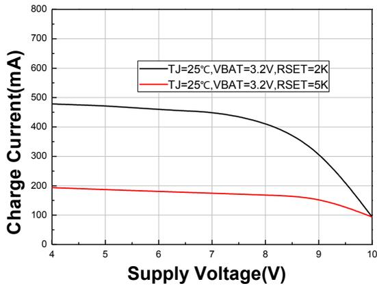
4. CHARGE 端电流 VS CHARGE 端电压 (充电时)
