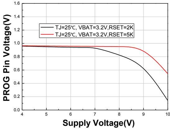
8. 涓流充电电流 VS 输入电压
