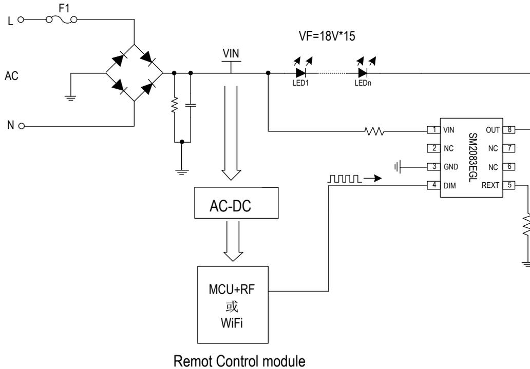
系统增加遥控控制电路可实现智能遥控灯的应用，控制电路的 PWM 信号通过对芯片的 DIM 端口控制，调节系统输出电流。遥控电路的控制部分可采用典型无线射频或蓝牙电路，通过遥控器或智能手机 APP 应用对智能灯进行控制。
