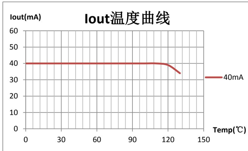
图 2. SM2083EGL 输出电流温度特性 (注 7)
